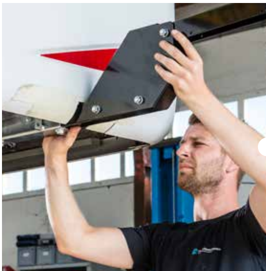
De hulpstukken voor de fietsendrager worden gemonteerd aan het hulpchassis
