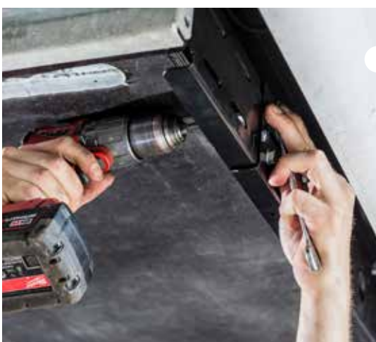
Een universele torsieplaat voorkomt torderen van het hulpchassis onder de garagevloer
