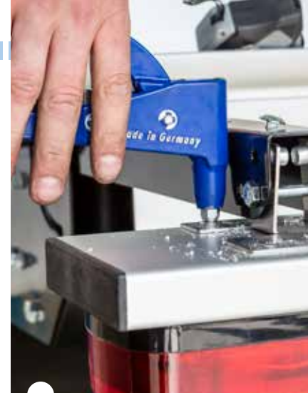
Het passend makend van de lichtbalk gebeurt pas als alles vastzit en is uitgelijnd
