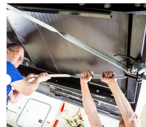
Diagonale versterking voorkomt elke mogelijke beweging in de trekhaakconstructie
