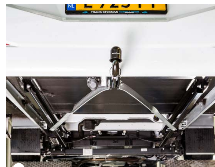
De lange trekhaakconstructie ligt tussen de originele Dethleffs-ondersteuning van de garagevloer
