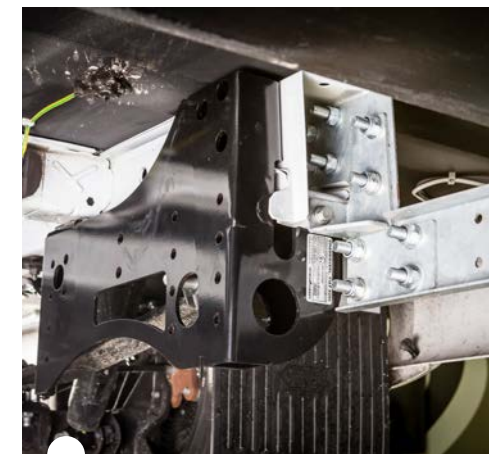
Met acht bouten per kant verbinden ijzersterke chassisadapters de chassisverlenging
